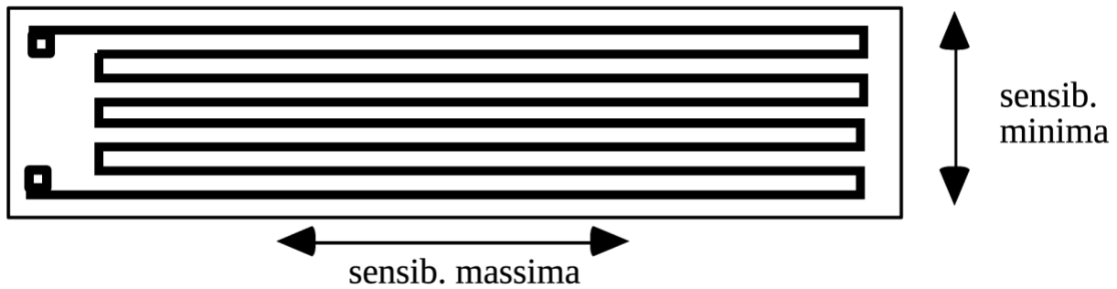
Tipica configurazione della pista di un estensimetro a film
