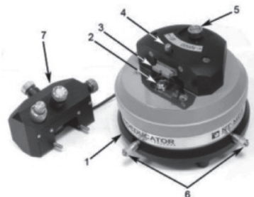
Figura 5. La testa di misura di NanoEducator: 1 - base, 2 - portacampione, 3 - sonda, 4 - vite di blocco della sonda, 5 - vite per spostamenti verticali, 6 - tavolo xy , 7 - videocamera.
