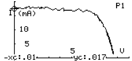
Figura 11. Andamento della corrente in funzione della tensione (illuminamento alto).
