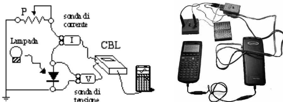
Figura 8. Circuito per lo studio della potenza erogata e foto dell'apparato.
