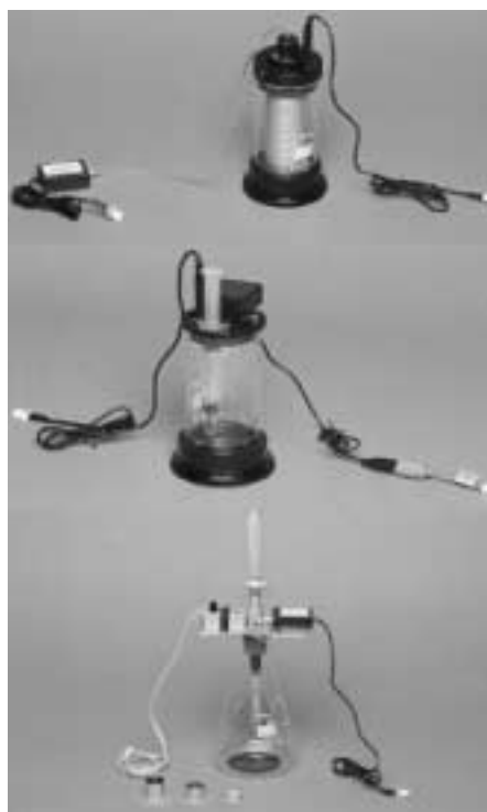
Figura 1: Trasformazioni termodinamiche dell'aria
