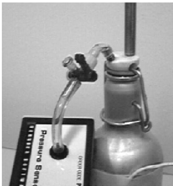
ancorato ad un'asta verticale per mantenerla ferma, dato che la spinta di Archimede tenderebbe a farla galleggiare (figura 1 e 2).
