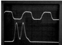
**Fig. 3: Segnali usati per misure di intervalli di tempo.**
