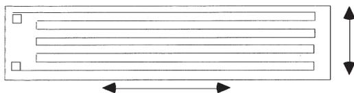
Fig. 9 - Tipica configurazione della pista di un estensimetro a film.
