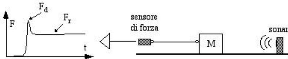
La misura inizia con il corpo fermo, poi **si muove a mano il sensore** (con velocità approssimativamente costante) e si registra un rapido incremento della forza misurata (la tensione del filo), che raggiunge un **picco** e **poi scende ad un valore inferiore**, praticamente costante per il resto del tempo in cui il corpo viene trascinato.
