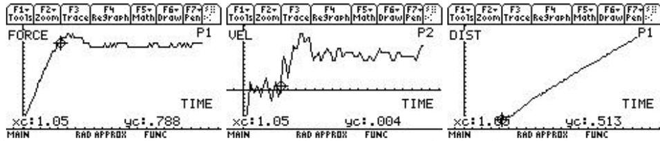
Figura 13: Come figura 12 , con molla di costante elastica  $k=1.2 \text{ kg/m}$   $Fd=0.8 \text{ N}$
