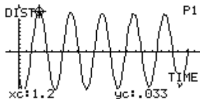
Figura 11: Oscillazioni della stessa barra su fulcro tondo con raggio R=6.5\text{ cm}
